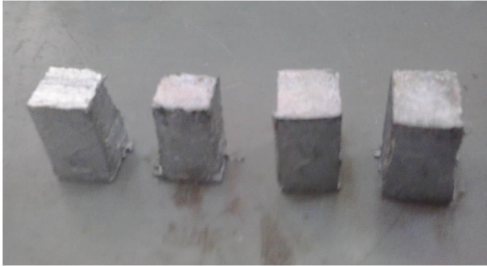
شكل (2): يمثل مسبوكات (Al – 22%Si) منتجة باستخدام منظومة سباكة الطرد المركزي العمودي عند درجة حرارة (850) م° وسرعة دوران (a) (625), (b) (1027), (c) (1144), (d) (1907) دورة/دقيقة.
