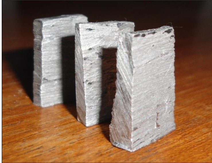
شكل (3): يمثل مسبوكة (Al – 22%Si) باستخدام منظومة سباكة الطرد المركزي العمودي عند سرعة دوران (1907) دورة /دقيقة.
