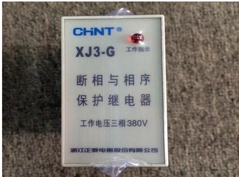
شكل (3) : وحدة مسلسل الأطوار (Phase sequence)
