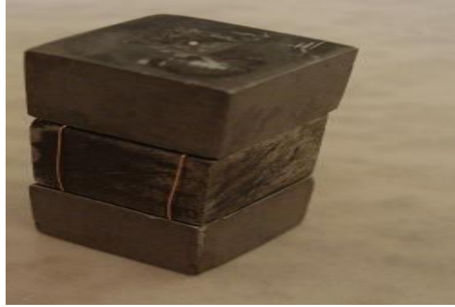
شكل (٢): العينات بعد ربطها بمادة الايبوكسي.
