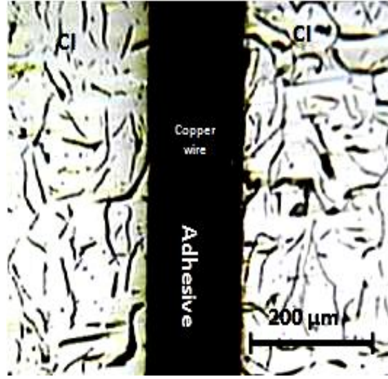
شكل (٧): الفحص المجهرى لمنطقة الربط لعينات متشابهة من حديد الزهر البيرلايتي.
